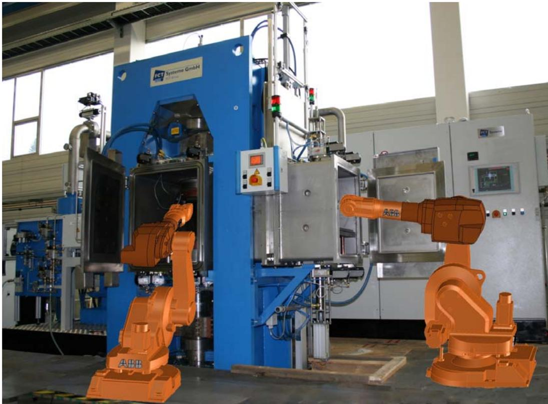
Abbildung 10. 250-Tonnen-Hybrid-Produktionsanlage mit FAST/SPS-Technik gemäß Abbildung 7, optional ausgestattet mit zwei ABB-Industrierobotern zum Befüllen und Entleeren.
