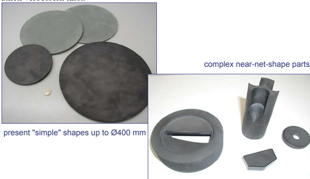
Abbildung 14. Derzeit laufende Entwicklung von einfachen Formen zu komplexen Geometrien
